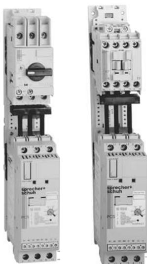
Les contrôleurs Sprecher + Schuh montés sur rail DIN peuvent être connectés directement à des contacteurs CA7 fournissant l'isolation ou à des contrôleurs de circuit moteur KT7 pour la protection du circuit d'alimentation (pour les modèles jusqu'à 37 A)
